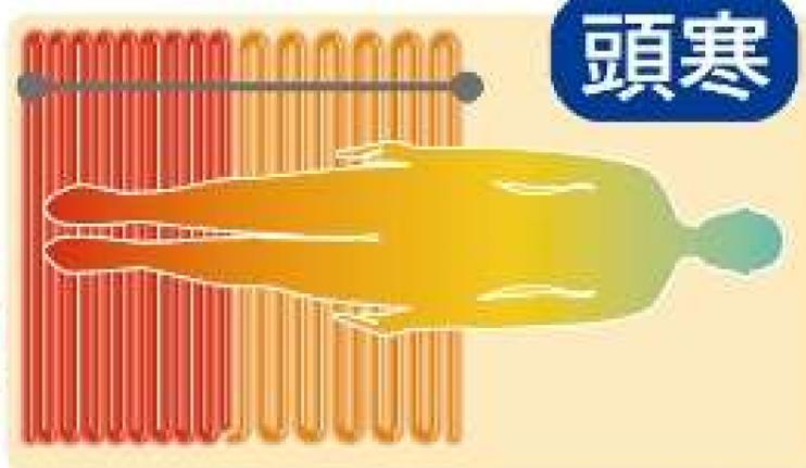
温熱出力の発熱体は、「感熱線一体型コードヒーター」を採用しています。これは発熱体を直接管理することで、温度安定性、温度分布、安全性などの面から特に優れています。
